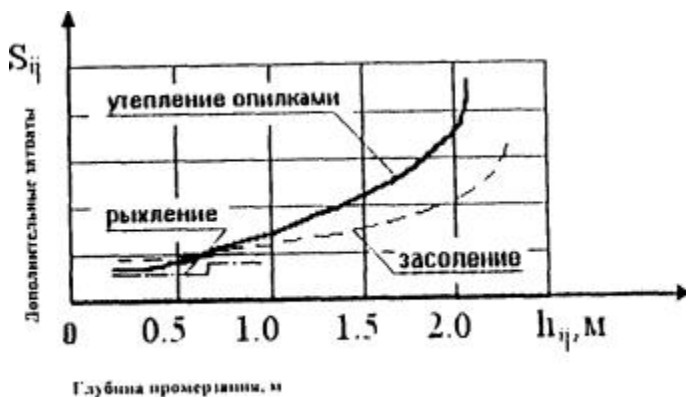
Рис. 4.3.1. Зависимость величины дополнительных затрат на подготовку грунтов к разработке от глубины промерзания
