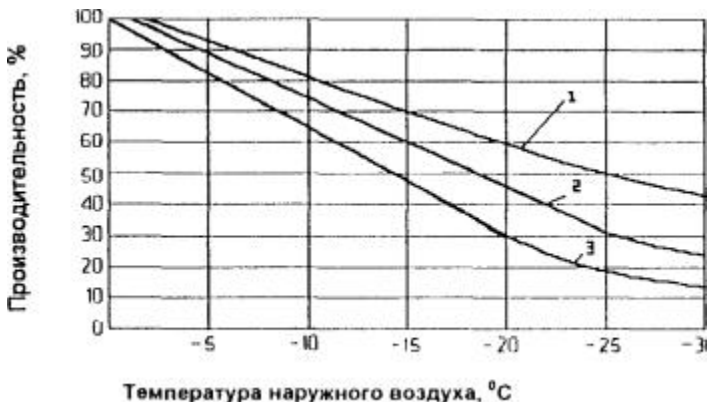
Рис. 4.3.2. Изменение производительности бульдозеров, скреперов, экскаваторов в зависимости от температуры воздуха:
